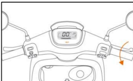
Se sugiere que después de acelerar usted gire nuevamente  $\frac{1}{4}$  de vuelta el acelerador devolviéndolo. Esto incrementará la autonomía y la vida útil de la batería.
