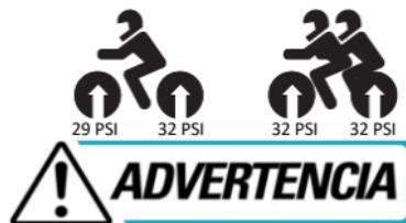
Las llantas nuevas pueden resultar resbaladizas y originar una pérdida de control o accidente en caso de no conducir con precaución, por lo tanto, es necesario un período de rodaje de 160 km para estabilizar la tracción normal de las mismas.
